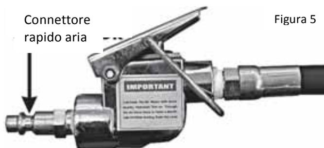
Impostare la pressione dell'aria tra 8 e 13 bar, a seconda della dimensione del compressore.
